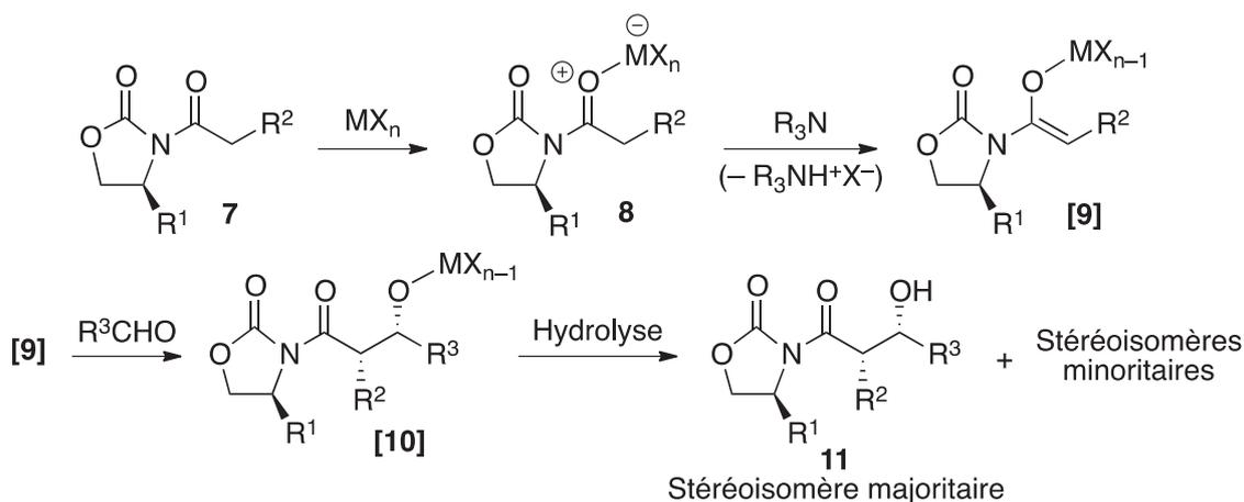
L'aldolisation d'Evans est conduite en présence d'un acide de Lewis  $\text{MX}_n$  qui facilite la formation de l'énolate *Z* **[9]** par déprotonation avec une amine tertiaire. Après hydrolyse, le composé **11** est isolé avec une excellente stéréosélectivité.
